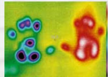
Es kann beobachtet werden, dass die Flachstapete die Wärme nicht an die Wand abgibt, sondern in sich aufnimmt. Sie wirkt somit isolierend.
